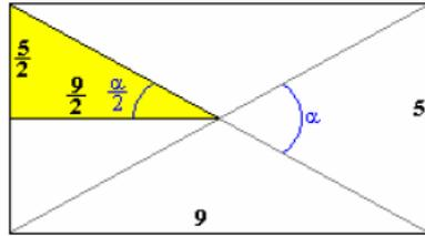
Observando la figura, el ángulo pedido se puede obtener por aplicación de la definición de tangente en el triángulo rectángulo coloreado.
