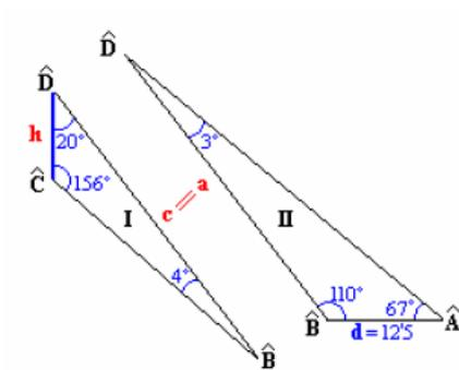
Una vez conocidos todos los ángulos, el problema se resuelve mediante dos triángulos oblicuángulos que comparten un lado como muestra la figura.
