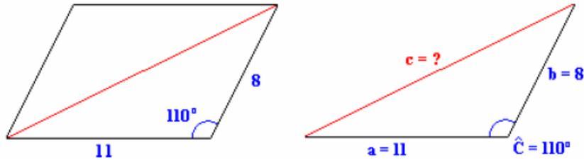
Dividiendo el paralelogramo en dos triángulos por la diagonal mayor se obtienen dos triángulos semejantes, del que se conoce dos lados y el ángulo que forman. El lado que falta (diagonal mayor,  $c$ ) se obtiene por el teorema del coseno.
