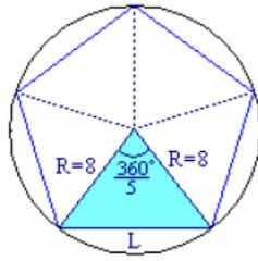
El pentágono regular se puede descomponer en cinco triángulos isósceles idénticos, de los que se conocerían la longitud de los lados iguales (el radio de la circunferencia) y el ángulo desigual, tal como muestra la figura.
