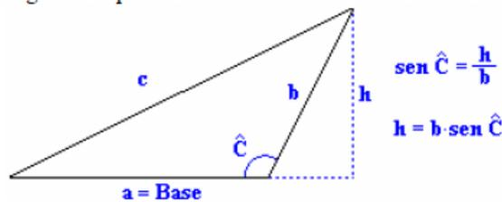
$$\text{Área Triángulo} = \frac{1}{2} a \cdot b \cdot \text{sen } \hat{C} = \frac{1}{2} 11 \cdot 8 \cdot \text{sen } 110^\circ = 41'3 \text{ m}^2$$
