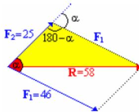
Del triángulo resaltado en la figura se conocen los tres lados, por tanto se puede aplicar el teorema del coseno para calcular  $\cos(180 - \alpha)$ .
