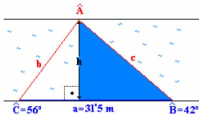
La anchura del río ( $h$ ) se puede obtener aplicando la definición del  $\text{sen } \hat{B}$  al triángulo rectángulo resaltado en la figura.
