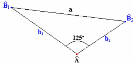
Triángulo oblicuángulo del que se conocen dos lados en función del tiempo y el ángulo que forman, y se pide la longitud del lado que falta. La solución se obtiene mediante el teorema del coseno.
