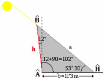
Para resolver el problema es conveniente nombrar los ángulos y lados del triángulo. Triángulo oblicuángulo del que se conocen dos ángulos ( $\hat{A}$ ,  $\hat{H}$ ) y un lado ( $b$ ).
