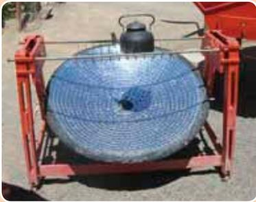
La cocina solar funciona con energía del Sol. Esta energía se transforma en energía lumínica y calor, que sirve para cocinar distintos alimentos.
