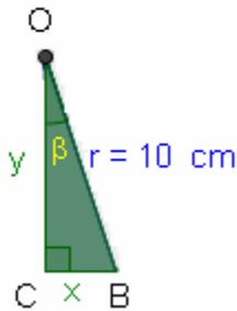
Llamamos a la apotema  $OC = y$  y a la mitad del lado  $CB = x$ . Como es un decágono regular cada uno de los diez triángulos tendrá un ángulo central  $\alpha = 360^\circ/10 = 36^\circ$  y por tanto  $\beta = \alpha/2 = 18^\circ$ .
