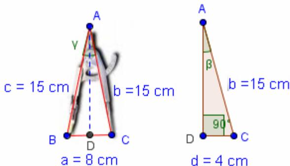
Las ramas del compás forman un triángulo isósceles, si tomamos si trazamos la altura AD y tomamos el triángulo rectángulo ADC:
