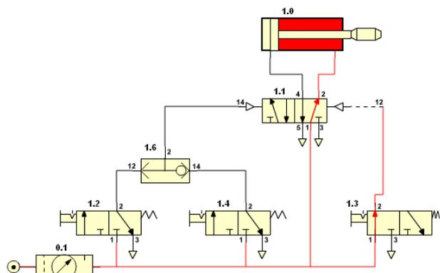
Cilindro de doble efecto con una puerta OR para el avance, retorno
