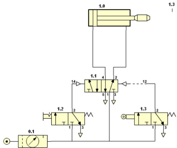
*Cilindro de doble efecto con retorno automático por final de carrera*
