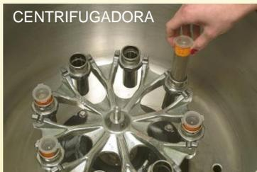
• Los componentes más densos de la mezcla migran hacia el fondo del tubo, en dirección al eje de centrifugación.
