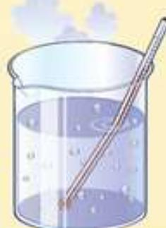
El galio se contrae (se deposita en la parte inferior del termómetro) cuando la temperatura desciende y se dilata (asciende) si aumenta la temperatura.
