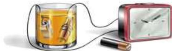
**4** Si no funciona, prueba a intercambiar los cables y observarás que empieza a funcionar.
