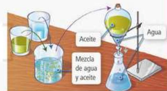
La **decantación** se usa para separar dos líquidos de distinta densidad. La mezcla se deja reposar en un recipiente llamado **embudo de decantación** hasta que los líquidos se separan. Al abrir la llave del embudo, el líquido más denso cae al recipiente.
