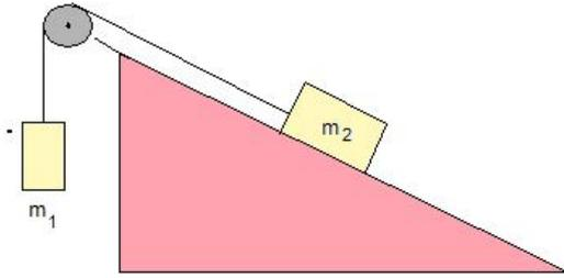
4.- Un bloque de masa  $m_2$ , está sobre un plano inclinado, unido a una polea como se ve en la figura. Deduzca la expresión de la aceleración del sistema. ¿Qué condiciones de masa deben darse para que el sistema se mueva en una dirección u otra?
