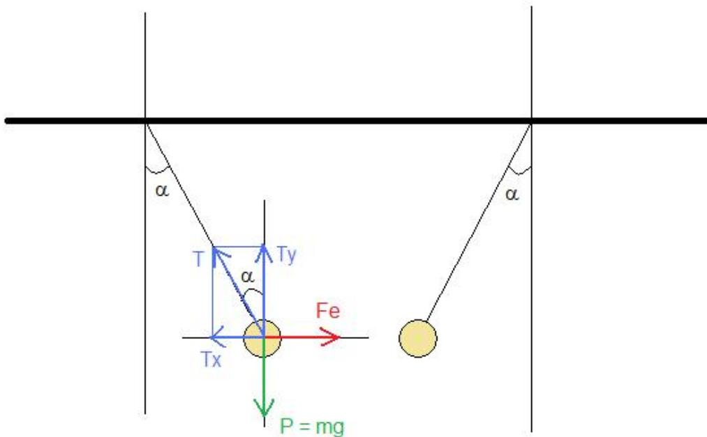
Analizaremos el movimiento por componentes, aplicando la segunda ley de la dinámica:
