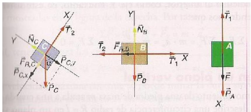
Aplicamos el segundo principio de la dinámica a cada cuerpo: ( $F = ma$ ):
