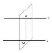
Calculamos el punto M, punto de corte de la recta s con el plano.
