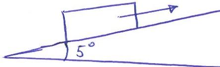
Sólo la componente del peso paralela a la rampa realiza trabajo. Ni la componente perpendicular del peso ni la normal realizan trabajo por ser perpendiculares al desplazamiento:
