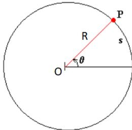
**Velocidad angular o velocidad de giro  $\omega$ .** En un MC llamamos *velocidad angular* o *velocidad de giro*  $\omega$  de la partícula en un instante a la derivada de la posición angular respecto del tiempo en dicho instante. Es una magnitud escalar instantánea, se mide en rad/s y da idea de lo rápido que cambia la posición angular.
