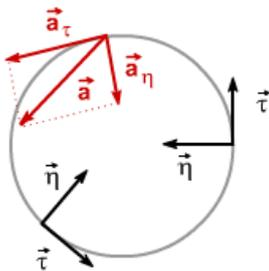
Recordamos que el vector aceleración mide lo rápido que cambia el vector velocidad, y que el vector velocidad puede cambiar al cambiar su módulo o al cambiar su dirección (para cambiar su sentido debe cambiar el módulo). Pasamos a estudiar  $a_\tau$ ,  $a_n$  y  $a$ .
