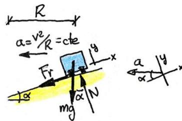
Elegimos los ejes como indica la figura; esto es, el eje  $x$  paralelo al peralte y hacia arriba, tal como hacíamos con las rampas, y el eje  $y$  perpendicular al peralte. Con estos ejes  $x$  e  $y$  (que no están en el plano del movimiento), la 2LN y la desigualdad del rozamiento quedan:
