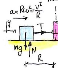
Se ofrece la vista de frente; visto desde arriba se veríamos al bloque girando con MCU. Por ser MCU la aceleración es la aceleración normal, que es  $a = R\omega^2 = \frac{v^2}{R}$
