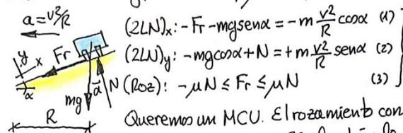
Queremos un MCU. El rozamiento con peralte funciona así. Si el vehículo está parado, el rozamiento es rampa arriba. A medida que el vehículo coge velocidad el rozamiento bajará su módulo, llegará un momento en el que cambiará de sentido (rampa abajo), irá aumentando su módulo hasta que no pueda más; momento en que el coche se saldrá de la carretera por superar su velocidad máxima.
