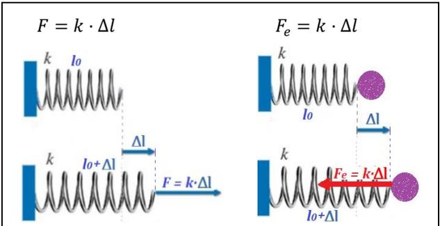
Para un muelle con un extremo fijo y el otro extremo solidario a una partícula, la ley de Hooke de un muelle y la fuerza elástica en forma vectorial quedan:
