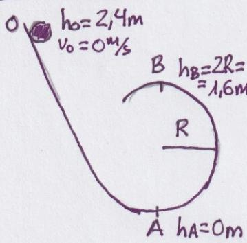
Datos:  $m = 0,4 \text{ kg}$ ;  $R = 0,8 \text{ m}$ ;  $h = 2,4 \text{ m}$ ; no hay rozamiento
