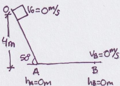
Datos:  $m = 8 \text{ kg}$ ;  $\mu = 0,2$ ;  $\alpha = 50^\circ$
