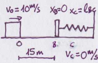
Datos:  $m = 5 \text{ kg}$ ;  $\mu = 0,25$ ;  $k = 2000 \text{ N/m}$ ;  $l_{BC} = 15 \text{ m}$
