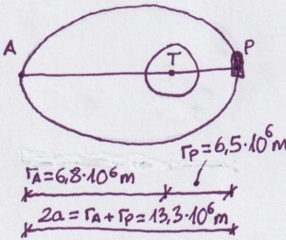
Datos:  $m = 2 \cdot 10^5 \text{ kg}$ ;  $r_p = 6,5 \cdot 10^6 \text{ m}$ ;  $r_A = 6,8 \cdot 10^6 \text{ m}$
