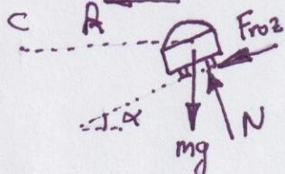
Datos:  $m = 800 \text{ kg}$ ;  $R = 100 \text{ m}$ ;  $\mu = 0,3$ ;  $\alpha = 5^\circ$
