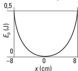
La lectura de la gráfica permite conocer la amplitud del movimiento  $A = 8 \text{ cm}$  y la energía potencial máxima, que coincide con la energía mecánica del oscilador:
