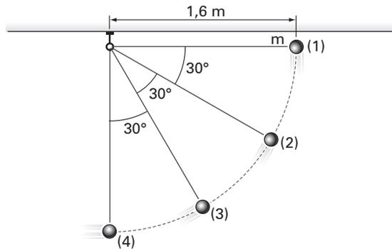
La masa del péndulo transforma energía potencial gravitatoria desde A hasta D en energía cinética. La energía mecánica se conserva en todo el proceso.
