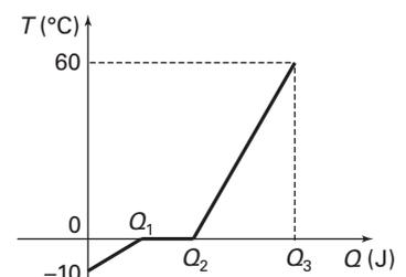
$Q_3$ : calor necesario para elevar la temperatura del agua desde 0 °C hasta 60 °C.
