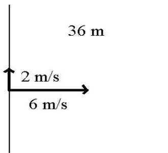
Tomando como eje X la dirección perpendicular a la de la corriente y como eje Y la dirección de la orilla y de la corriente, las ecuaciones del movimiento son:
