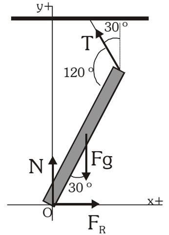
Descomponiendo la tensión:  $T_x = T \cdot \text{sen}30^\circ$ ,  $T_y = T \cdot \text{cos}30^\circ$
