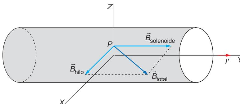
El módulo del campo magnético que crea el conductor rectilíneo se calcula aplicado la ley de Biot y Savart:
