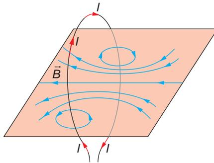
Para explicar la forma de dichas líneas de fuerza, considera que la corriente circular está formada por elementos de corriente rectilíneos, cada uno de los cuales forma su propio campo, que será perpendicular a la dirección de la corriente y cuyo sentido vendrá determinado por la aplicación de la regla de Maxwell.
