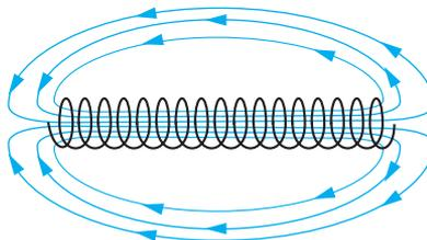
b) Como se aprecia en la figura anterior, las líneas de campo en el interior del solenoide y, en particular, en su eje, tienen la dirección señalada por la longitud de este. Por tanto, cuando la partícula entra en el solenoide con velocidad coincidente con su eje, los vectores velocidad y campo magnético son paralelos. En consecuencia, la fuerza magnética que actúa sobre la partícula es nula:
