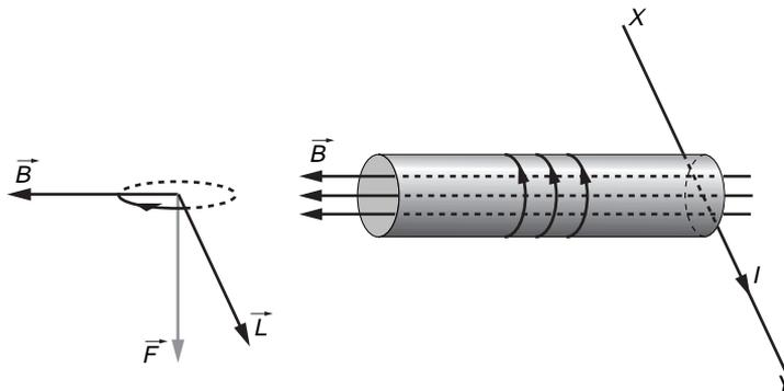
Aplicando de nuevo la ley de Laplace, vemos que, de acuerdo con la regla del tornillo, se ejerce sobre el conductor una fuerza hacia abajo, como se aprecia en la figura. Por tanto, el conductor se desplazará hacia abajo.
