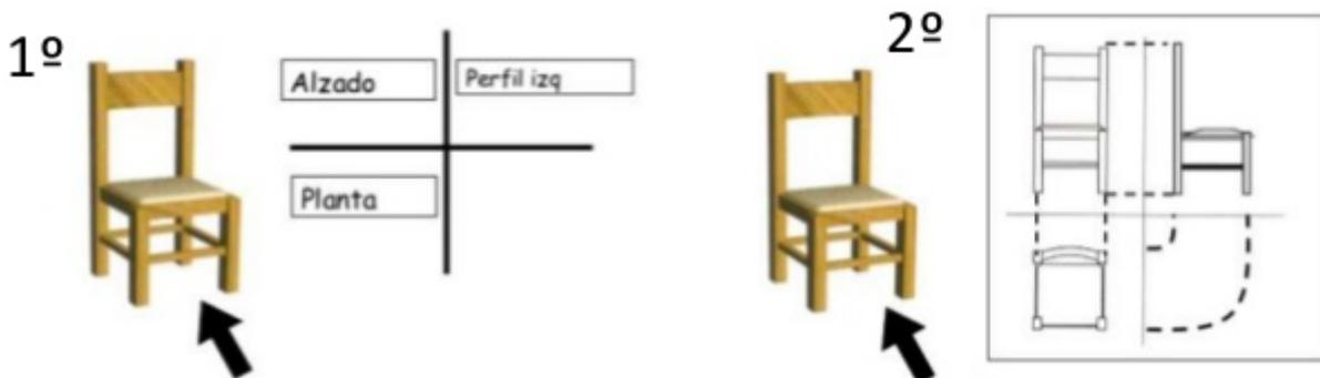
2. Empieza dibujando el alzado y prolonga una finas líneas auxiliares discontinuas con lápiz a lo alto y ancho de la figura dibujada
