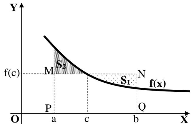
La interpretación geométrica puede observarse en las figuras anteriores. El área  $S$  de la primera figura es equivalente al área del rectángulo de vértices  $PMNQ$ , cuya base es  $(b - a)$  y su altura es  $f(c)$ .
