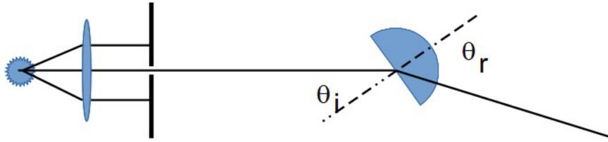
b) Para calcular el índice de refracción utilizaremos la ley de Snell.
