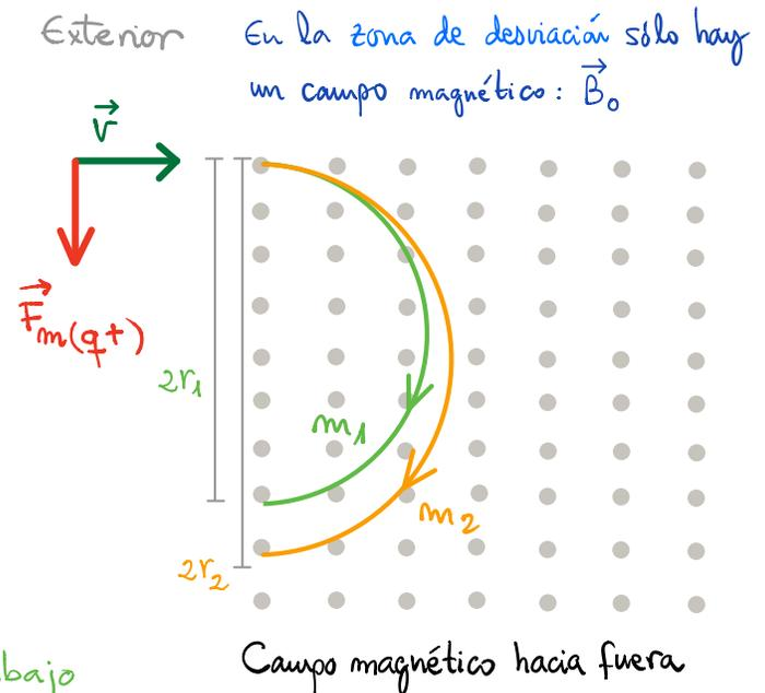
4. **CUESTIÓN (Justifica la respuesta):** Calcula teóricamente el incremento de energía cinética de las cargas que parten del reposo dentro de un **ciclotrón** después de describir **1 vuelta completa**:
