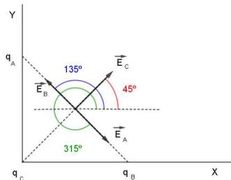
$$\vec{E} = 0 = \frac{Kq_A}{2} \left( \vec{i} \cos 315^\circ + \vec{j} \sin 315^\circ \right) + \frac{Kq_B}{2} \left( \vec{i} \cos 135^\circ + \vec{j} \sin 135^\circ \right) + \frac{Kq_C}{2} \left( \vec{i} \cos 45^\circ + \vec{j} \sin 45^\circ \right)$$
