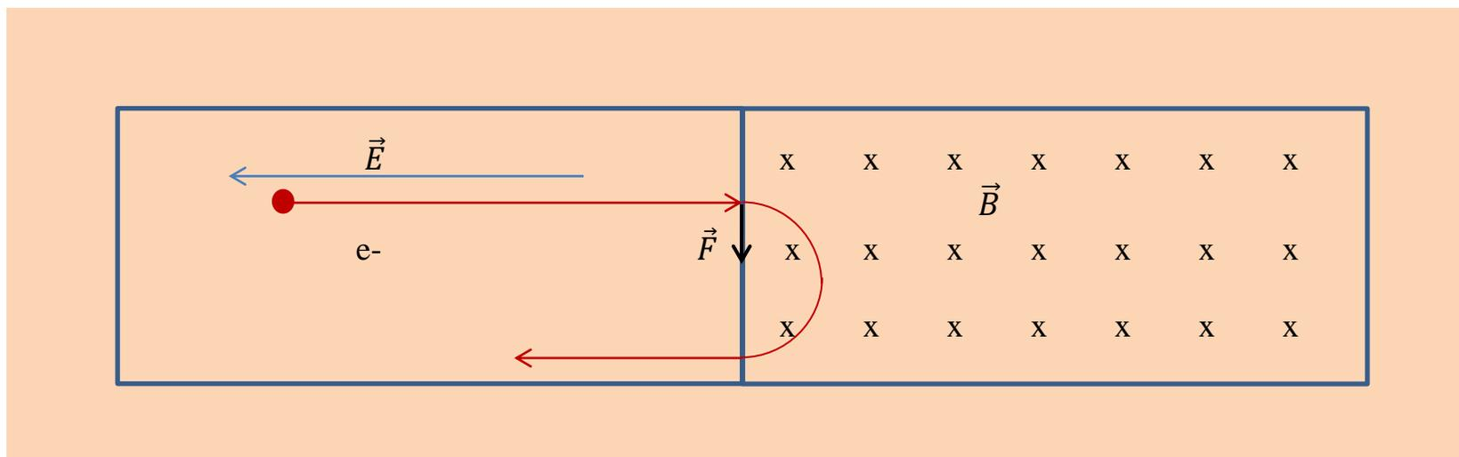
Las cruces indican que el campo magnético se dirige hacia dentro. La fuerza magnética en cada punto de la trayectoria circular es perpendicular a dicha trayectoria y se deduce mediante la regla de la mano izquierda, pero recordando que debemos invertir el sentido obtenido, ya que la carga es negativa.
