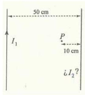
que el campo magnético total creado por ambas corrientes en el punto P es nulo. Calcular: a) El valor de la intensidad de corriente  $I_2$  y su sentido. Justificar razonadamente la respuesta. b) La fuerza que por unidad de longitud ejerce el conductor 2 sobre el 1, expresando su módulo, dirección y sentido. Permeabilidad magnética del vacío:  $\mu_0 = 4\pi \cdot 10^{-7} \text{ N/A}^2$ .
