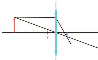
4. Una lente delgada convergente con una distancia focal imagen de 18 cm forma una imagen real e invertida que es 3 veces más grande que el objeto. a) Calcular las posiciones del objeto y de la imagen respecto a la lente. b) Realizar el diagrama de rayos correspondiente.
