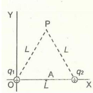
campo eléctrico total debido a estas dos cargas en el tercer vértice P del triángulo es de  $292,3 \text{ N/C}$ . Calcular: a) El valor de la carga eléctrica  $q$ . b) El trabajo que es necesario realizar para transportar otra carga puntual positiva  $q_0 = 5 \times 10^{-6} \text{ C}$ , desde el punto P hasta el punto A situado en el centro de la base del triángulo, sin variar su energía cinética. Constante de Coulomb:  $k = 9 \times 10^9 \text{ N m}^2 \text{C}^{-2}$ .
