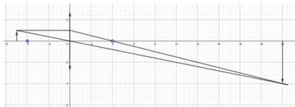
33. Una lente divergente produce una imagen  $y'$  que es 4 veces menor que el tamaño  $y$  del objeto cuando la separación entre la imagen y el objeto es 54 cm. a) Calcular las posiciones  $s$  y  $s'$  del objeto y de la imagen, respectivamente. b) Calcular la distancia focal  $f$  de la lente.
