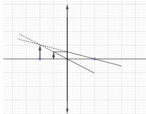
25. Un objeto de 3 cm de altura está situado a 20 cm a la izquierda de una lente delgada divergente de -10 dioptrías. a) Calcular la posición y la altura de la imagen. b) Realizar el diagrama de rayos correspondiente.
