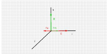
Lo cual se produciría cuando el electrón se desplace en **sentido positivo del eje y**.
