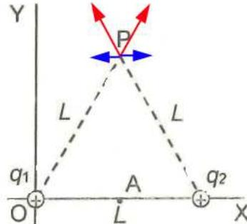
Podemos ver que las componentes horizontales de los vectores campo eléctrico se anulan entre sí. El módulo del campo resultante será:  $|\vec{E}_r| = 2 |\vec{E}_y|$ , siendo  $\vec{E}$  el campo creado por cualquiera de las dos cargas en el punto P, y  $\vec{E}_y$  la componente vertical de cada uno. así pues:
