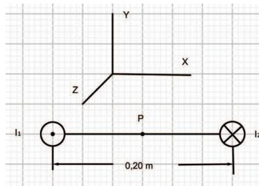
Calcular: a) El vector campo magnético total en el punto P, expresando su módulo, dirección y sentido. b) La fuerza magnética por unidad de longitud que ejerce el conductor 1 sobre el 2, expresando su módulo, dirección y sentido. Permeabilidad magnética del vacío:  $\mu_0 = 4\pi \cdot 10^{-7} \text{ N/A}^2$ .
