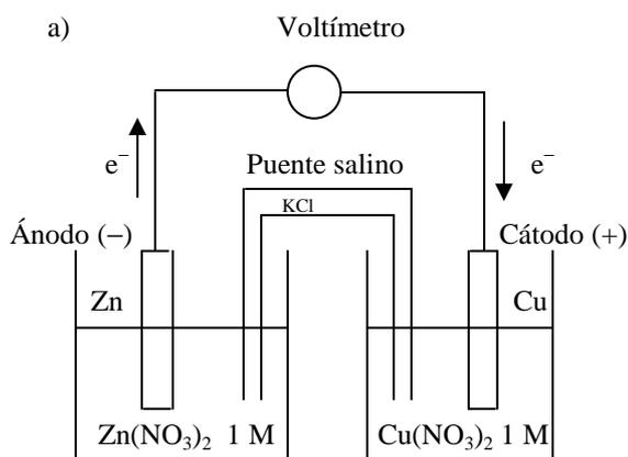
La función del puente salino es la de cerrar el circuito y mantener la neutralidad eléctrica de las disoluciones.
