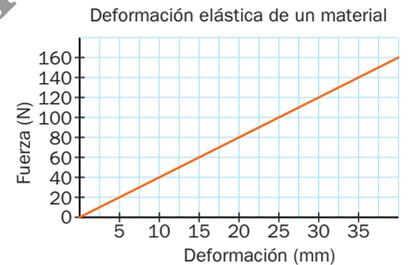
En este material, por cada 5 milímetros de deformación se requiere un aumento de 20 newtons en la fuerza deformadora.
