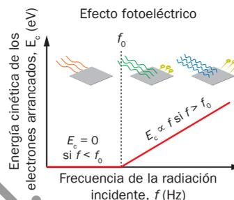
Por debajo de una frecuencia umbral,  $f_0$ , la luz que incide en un metal no arranca sus electrones; por encima, estos salen con una energía cinética,  $E_c$ , proporcional a la frecuencia,  $f$ , de la radiación incidente.
