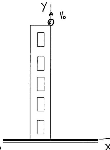
a) SISTEMA DE REFERENCIA EN LA BASE DEL EDIFICIO
