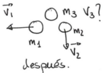
$$\vec{P}_{\text{antes}} = \vec{P}_{\text{después}}$$
