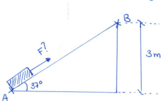
②8) Se desea subir un cuerpo de 20Kg por una rampa de  $37^\circ$  de inclinación. ¿Qué fuerza paralela al plano se necesita para que ascienda con velocidad constante?  $\mu = 0'15$
