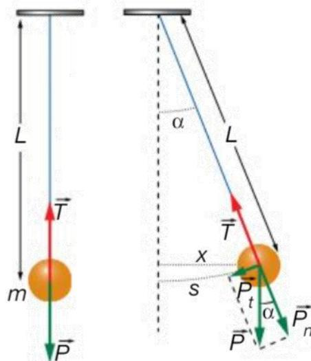
El sistema descrito recibe el nombre de **pendulo simple**. cuando se aleja de la posición de equilibrio la componente normal del peso se ve contrarrestada por la tensión de la cuerda, y la resultante coincide con la componente tangencial. Aplicando la 2ª ley de Newton:
