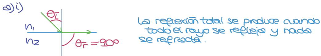
Para que el rayo refractado se aleje de la normal hasta convertirse en  $90^\circ$  el rayo debe pasar de un medio más denso a otro menos denso ( $n_1 > n_2$ ). En este caso, la  $v$  o  $\lambda$  aumenta de un medio a otro.
