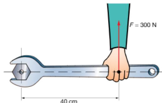
Solución:  $M = 120 \text{ N} \cdot \text{m}$ ;  $M' = 480 \text{ N} \cdot \text{m}$ .
