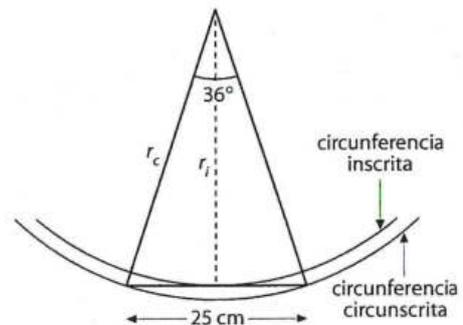
Este decágono se puede descomponer en diez triángulos isósceles de ángulo desigual  $36^\circ$  y de lado desigual 25 cm.
