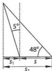
Si la estaca está inclinada «hacia el Sol» respecto de la vertical, según se observa en la figura:
