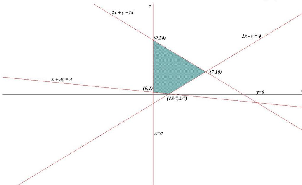
$$f(x, y) = 3x + y \text{ sujeto a: } \begin{cases} x + 3y \geq 3 \\ 2x - y \leq 4 \\ 2x + y \leq 24 \\ x \geq 0, y \geq 0 \end{cases}$$
