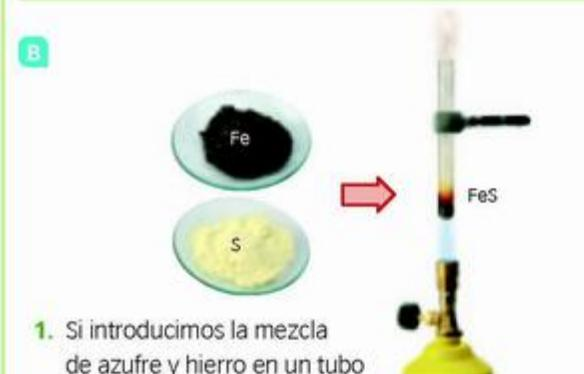
1. Si introducimos la mezcla de azufre y hierro en un tubo de ensayo y lo calentamos a temperatura elevada, aparece una nueva forma de materia: el sulfuro de hierro ( $\text{FeS}$ ).
