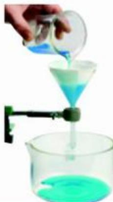
2. Si hay polvo o alguna sustancia no disuelta, filtralo con un embudo y papel de filtro. Vierte la disolución en un cristizador y déjala en reposo en un sitio ventilado.
