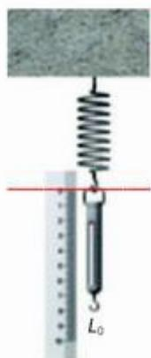
2. Tira con una fuerza (mide su valor con el dinamómetro) y anota la posición del extremo del muelle en la regla,  $L$ . La diferencia  $L - L_0$  ( $\Delta L = L - L_0$ ) es lo que se ha estirado por acción de esta fuerza. Anota los resultados en la tabla.
