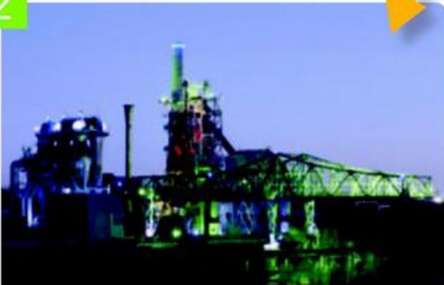
En un **alto horno** se calienta el mineral junto con carbón a una temperatura elevada. Así se obtiene el metal hierro. Si el hierro lleva entre el 0,05 % y el 1 % de **carbono**, es acero.
