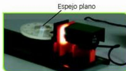
2. Coloca el espejo plano formando un cierto ángulo con los rayos y observa el rayo reflejado. Experimenta con otras orientaciones del espejo.
