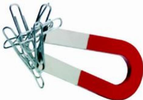
Cuando un imán atrae a un objeto metálico, dicho objeto puede convertirse de manera temporal en un nuevo imán y atraer a otros objetos metálicos. Es lo que ocurre con los clips metálicos en esta fotografía.
