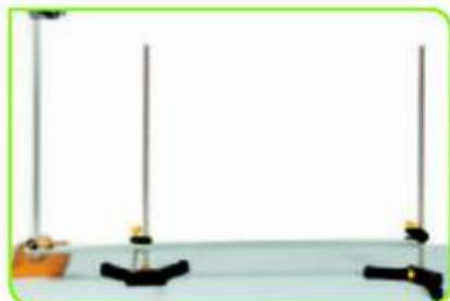
1. Coloca el rail casi horizontal. Y pon la bola de madera parada cerca de uno de sus extremos.
