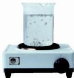
2. Enciende la placa calefactora y observa el movimiento de las virutas dentro del vaso.
