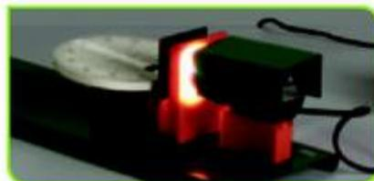
1. Sobre el banco óptico coloca el foco, la lente convergente, el diafragma de tres ranuras y el disco de Hartl. Acerca o aleja la lente del foco hasta que consigas tres rayos paralelos sobre el disco.
