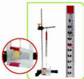
6. Rodea otro imán con vidrios de portaobjetos formando una caja. Coloca ahora el imán colgando del dinamómetro dentro de la caja de manera que ambos imanes se repelan. Anota el peso que marca el dinamómetro.
