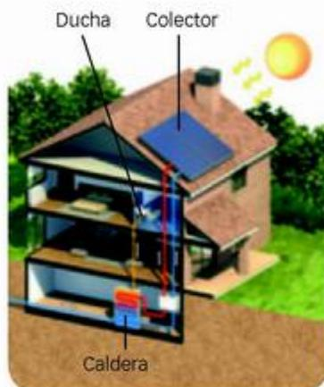
En el tejado pueden colocarse **colectores solares**: unos paneles de vidrio en cuyo interior hay tubos por los que circula agua. La energía del Sol calienta el agua, que se usa para el consumo doméstico.
