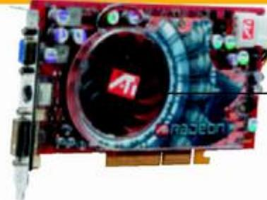
El ventilador sirve para refrigerar los circuitos.
