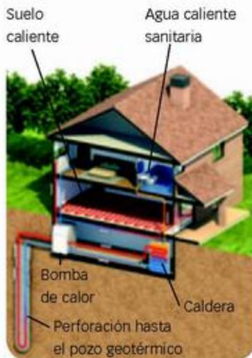
Una perforación hasta un pozo geotérmico permite obtener la energía **geotérmica** del interior de la Tierra.
