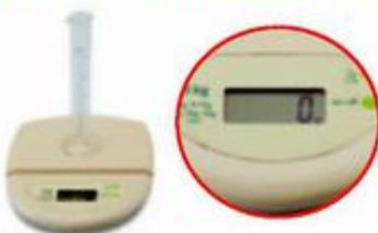
1. Enciende la balanza, coloca la probeta vacía sobre ella y tálala (ponla a cero).
