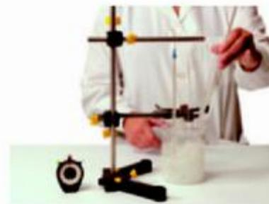
4. Cuando la temperatura dentro del tubo esté entre  $-5$  y  $-10\text{ }^{\circ}\text{C}$ , saca el tubo. El termómetro quedará incrustado en el hielo.
