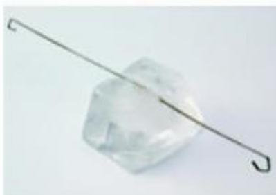
Por encima del alambre, el agua, que ya no está sometida al exceso de presión, vuelve a congelarse, y así se recompone el bloque de hielo.
