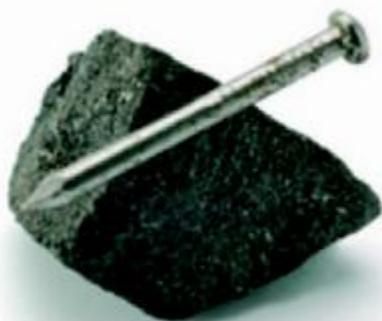
La **magnetita** es un mineral capaz de atraer a los objetos elaborados con hierro, acero y otros materiales metálicos.
