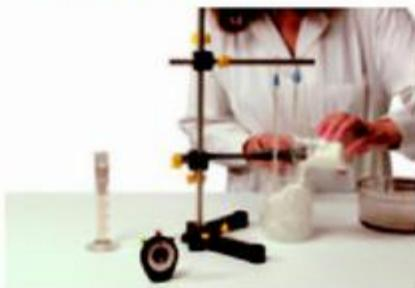
1. Prepara la mezcla frigorífica. Coloca todo como en la foto. Vierte capas de hielo y sal en el vaso. Comprueba que la temperatura llega a  $-15\text{ }^{\circ}\text{C}$ .
