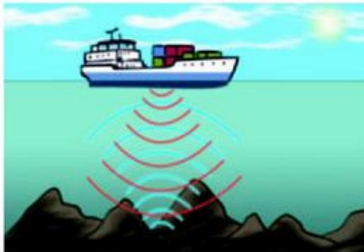
El **sonar** (*Sound Navigation And Ranging*, navegación por sonido) se inventó para facilitar la navegación, localizando obstáculos no visibles como icebergs o rocas del fondo. Hoy se emplea para cartografiar el fondo marino, localizar barcos hundidos o bancos de peces.
