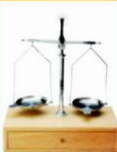
1. Con la balanza en reposo, se pone en un platillo el objeto cuya masa se quiere medir y en el otro se colocan las pesas.
