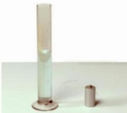
2. Echa agua en la probeta hasta un nivel intermedio y anótalo. Por ejemplo, 150 mL.
