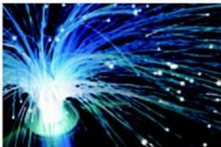
Se puede utilizar la reflexión de ondas electromagnéticas para transmitir señales de telecomunicación (textos, fotografías, sonidos y videos) en las **fibras ópticas**. Son hilos muy finos de material transparente, vidrio o materiales plásticos, por la que pasa la luz que lleva los datos a transmitir.
