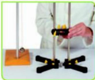
1. Haz un péndulo. Coloca guías metálicas en la nuez de cada uno de los dos soportes de forma que estén a la misma altura.
