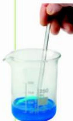
1. En un vaso de precipitados de 250 mL, echa 50 mL de agua. Pesa 15 g de sulfato de cobre pentahidratado y disuélvelos en el agua. Para disolver, agita, y si es necesario, calienta la disolución.
