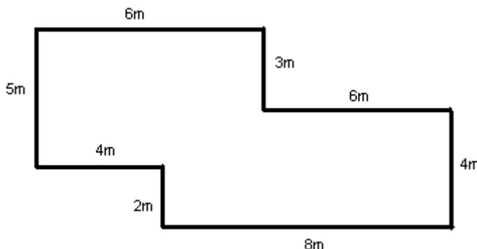
Todas las paredes son de ladrillo. La altura del local es de 2,5 m. Espesor de la pared: 20 cm. Conductividad del ladrillo:  $\lambda_l = 0,7$  Kcal/(h.m.°C) Superficie acristalada: 25 m<sup>2</sup>. Espesor del cristal: 4 cm. Conductividad del cristal:  $\lambda_c = 0,33$  Kcal/(h.m.°C) Se desprecian las pérdidas de calor
