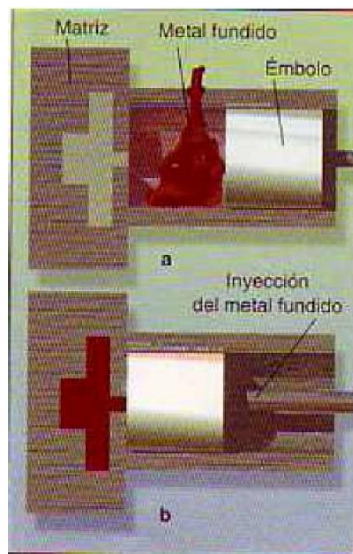
Fig. 6. Proceso de inyección de metal fundido en la matriz.
