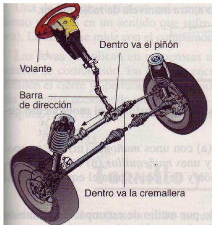
Figura 13.15. Caja de dirección de un automóvil (esquema).
