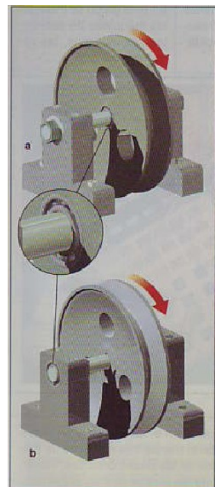
Fig. 2. Tipos de ejes: a) fijo; b) giratorio.
