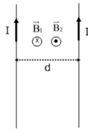
Por la regla de la mano derecha, el hilo de la izquierda produce un campo magnético  $\vec{B}_1$  entrante en el papel en la zona entre los dos hilos. De la misma forma, el hilo de la derecha produce un campo magnético  $\vec{B}_2$  saliente, en este caso y en la misma zona. En el punto medio entre los dos hilos  $\vec{B}$  total se anula
