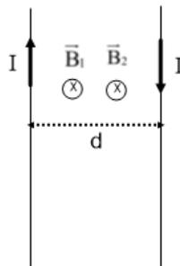
Aplicando la regla de la mano derecha, se observa que los vectores  $\vec{B}_1$  y  $\vec{B}_2$  tienen el mismo sentido, luego, no se anulan en ningún punto entre los dos hilos.  $\vec{B}_{\text{Total}} = \vec{B}_1 + \vec{B}_2 \neq 0$
