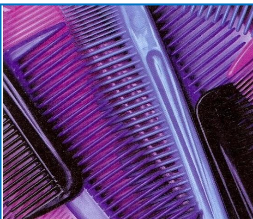
El caucho vulcanizado con alto contenido en azufre sirve para realizar peines.
