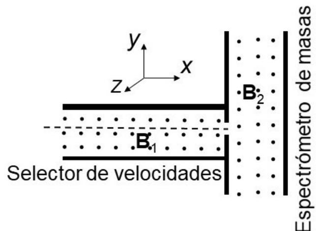
velocidades los campos eléctrico y magnético son  $\vec{E} = 4,0 \cdot 10^5 \vec{j} \text{ V m}^{-1}$  y  $B_1 = 2 \vec{k} \text{ T}$ . El campo magnético en la segunda región del espectrómetro de masas es  $\vec{B}_2 = 5 \vec{k} \text{ T}$ . Calcule:
