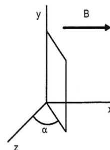
a) Si se hace girar la espira alrededor del eje Y con una frecuencia de rotación de  $60 \text{ Hz}$  siendo  $\alpha = \pi/2$  en el instante  $t = 0$ , obtenga la expresión de la fuerza electromotriz inducida en la espira en función del tiempo.
