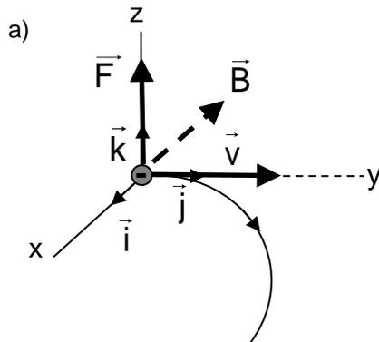
De acuerdo con el esquema que se muestra, si el electrón (carga negativa) está sometido a una fuerza  $\vec{F} = q(\vec{v} \wedge \vec{B})$ , dirigida en el sentido positivo del eje Z, describirá una trayectoria circular en el sentido de las agujas del reloj y situada en el plano YZ, plano del papel. Para eso el campo magnético ( $\vec{B}$ ) deberá de estar orientado según la dirección negativa del eje X (perpendicular al plano del papel y entrante). Su valor sería:
