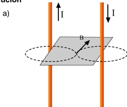
Al circular la misma corriente, pero en sentidos opuestos, ambos conductores crearán en el punto medio de la recta que los separa un campo magnético perpendicular al plano que contiene a los conductores y entrante (ver figura).
