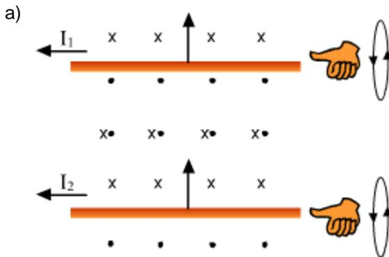
Como se puede ver en la figura (donde el punto significa campo perpendicular al plano del papel y saliente, y la cruz campo perpendicular y entrante) en el espacio comprendido entre ambos conductores los campos magnéticos creados son de la misma dirección (perpendiculares al plano del papel) pero sentido distinto, así que los campos se restan.
