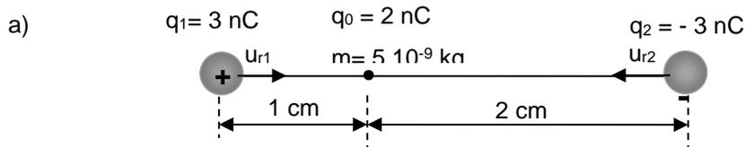
$$\vec{F}_+ = k \frac{q_1 q_0}{r_1^2} \vec{u}_{r1} = \left( 9 \cdot 10^9 \frac{\text{N} \cdot \text{m}^2}{\text{C}^2} \frac{3 \cdot 10^{-9} \text{C} \cdot 2 \cdot 10^{-9} \text{C}}{(10^{-2} \text{m})^2} \right) \vec{i} = (5,4 \cdot 10^{-4}) \vec{i} \text{ (N)}$$
