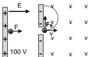
$$r = \frac{m v}{q B} = \frac{4(1,67 \cdot 10^{-27}) \text{ kg} \cdot 9,8 \cdot 10^4 \frac{\text{m}}{\text{s}}}{2(1,6 \cdot 10^{-19}) \text{ C} \cdot 0,1 \text{ T}} = 0,0196 \text{ m} \approx 2 \text{ cm}$$
