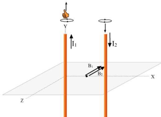
$$B = \frac{\mu_0 I}{2 \pi d} = \frac{4 \pi \cdot 10^{-7} \text{ T} \cdot \text{m} \cdot \text{A}^{-1} \cdot 2 \text{ A}}{2 \pi \cdot 0,2 \text{ m}} = 2 \cdot 10^{-6} \text{ T} = 2 \mu\text{T}$$
