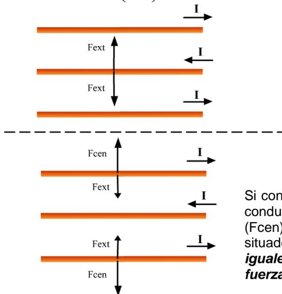
Si los tres conductores están situados en paralelo, tal y como se muestra en la figura, los hilos extremos repelerán al conductor central con idéntica fuerza, razón por la que **la fuerza total actuante sobre este conductor será nula**.
