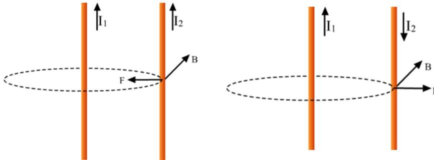
**Cuando por dos hilos paralelos circulan corrientes en el mismo sentido los conductores se atraen, y cuando circulan en sentido contrario, se repelen** (ver imagen).
