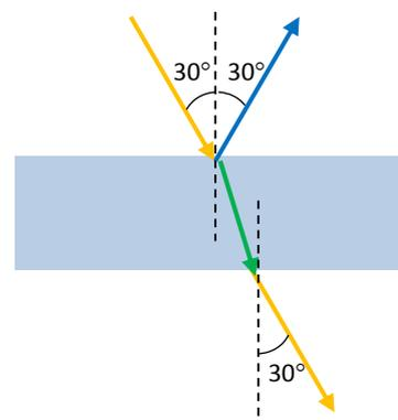
9. Un rayo de luz incide con un ángulo de incidencia de  $30^\circ$  sobre una lámina de vidrio de 4 cm de espesor. La velocidad de propagación de la luz dentro de la lámina es  $2/3$  la velocidad de la luz en el vacío. Calcula:
