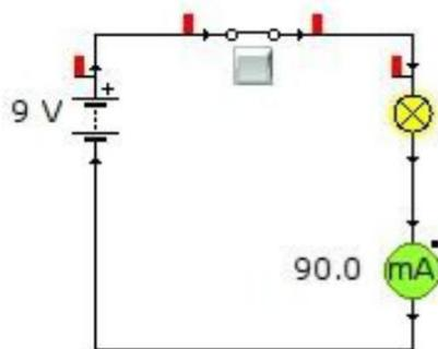
Puedes observar que el amperímetro, se coloca a continuación del bombillo, es decir, insertado dentro del circuito. En este caso, el amperímetro marca 90 miliamperios (mA). Esta es la intensidad de la corriente que atraviesa el bombillo.
