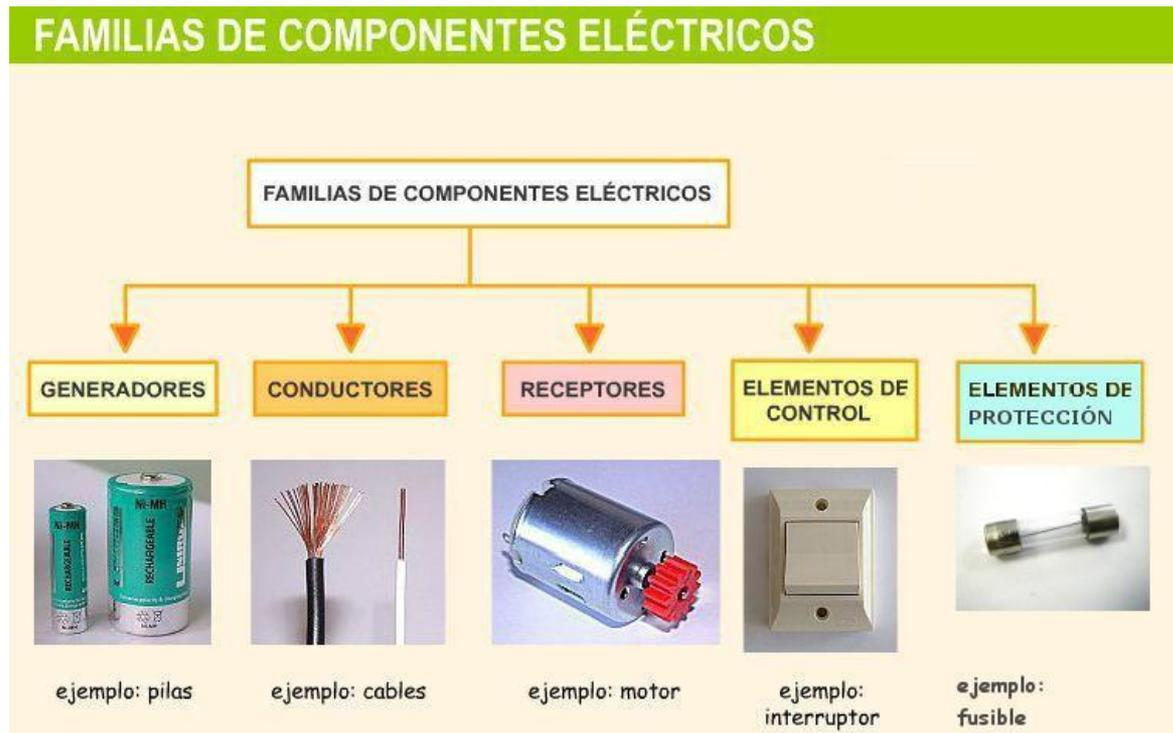
**Generadores:** Los generadores son los elementos que transforman cualquier forma de energía en energía eléctrica, es decir, los generadores suministran energía eléctrica al circuito.
