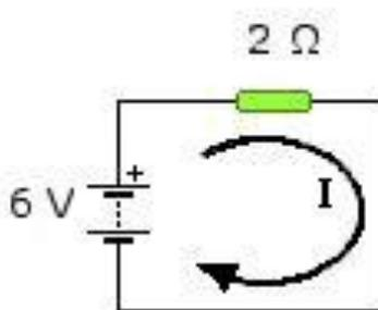
*Un circuito que tiene una pila de 6 voltios genera una corriente que atraviesa una resistencia eléctrica de 2 ohmios. ¿Cuál es el valor de la intensidad de la corriente que pasa por la resistencia?*
