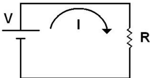
Conectamos una resistencia  $R$  a una fuente de tensión de voltaje  $V$ , por la resistencia circula una corriente de intensidad de corriente  $I$ .
