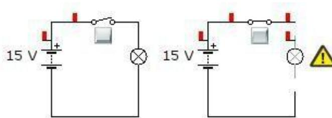
Para evitar que se funda, podemos colocar una resistencia en serie con la bombilla para que se quede con, al menos, los 10 V que nos sobran. Así, sólo le llegarán 5 V a la bombilla. De este modo, la resistencia, actúa como un receptor extra que se opone al paso de la corriente y limita la intensidad de la misma, protegiendo el bombillo de una sobre carga.
