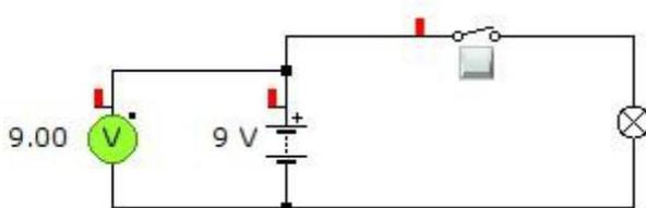
se coloca el voltímetro como muestra el dibujo de la izquierda. Se puede observar que el voltímetro nos da un resultado de 9 V, lo cual es lógico.
