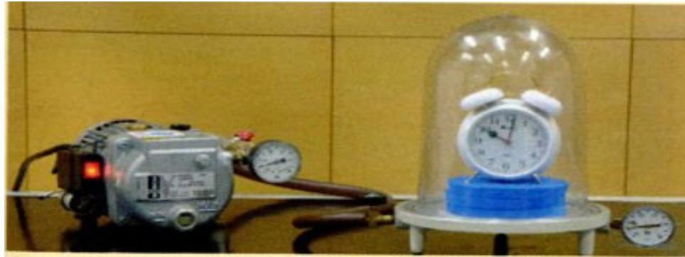
Experimento del reloj en una campana de vacío
