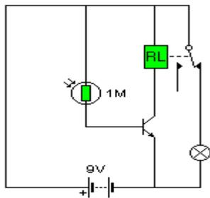
13- Analiza el funcionamiento del siguiente circuito cuando el potenciómetro tiene poca resistencia y cuando tiene mucha.
