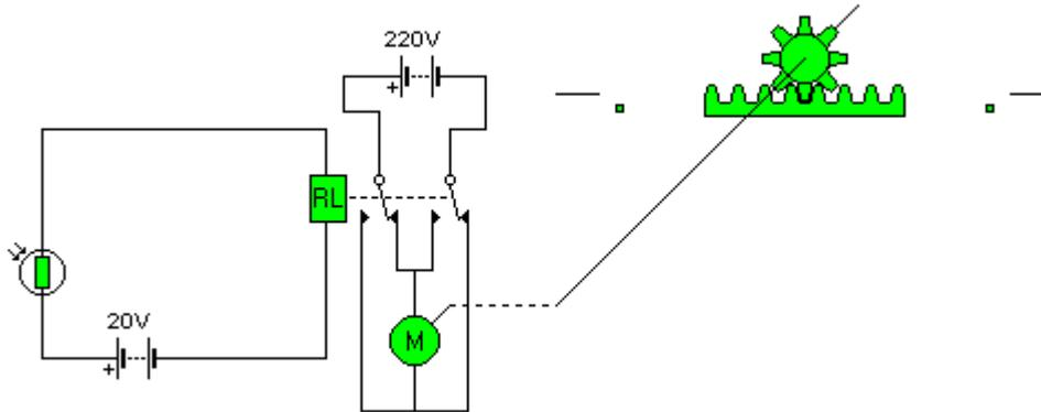
8- Diseña el esquema de un circuito para la puesta en marcha de un motor cuando hay mucha luz y cuando hay poca luz se encienda una bombilla. Componentes mínimos:
