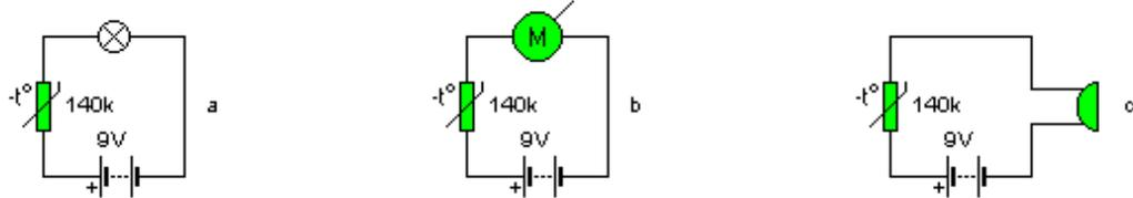
7- Queremos diseñar un circuito que encienda un ventilador cuando aumente la temperatura. ¿Sería correcto el siguiente montaje? Explica su funcionamiento. Considera que está instalada una NTC
