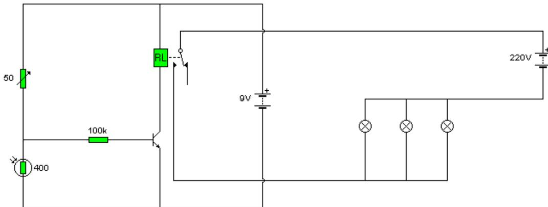
19- El siguiente circuito corresponde al indicador de fallos en las luces posteriores de un coche. Este dispositivo entra en funcionamiento cuando accionamos el interruptor de encendido. Explica porqué cuando en alguno de los pilotos se funde una bombilla se enciende en el salpicadero un indicador de fallo. Ten en cuenta que las LDR están colocadas dentro del piloto del coche para detectar si la bombilla está encendida o apagada.
