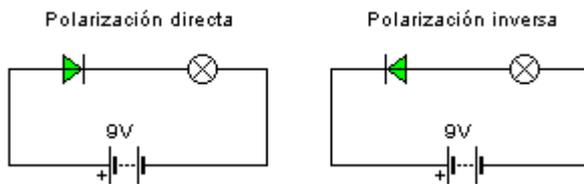
Cuando conectamos el polo positivo del diodo con el positivo de la pila y el negativo del diodo con el negativo de la pila, la polarización es directa y deja pasar la corriente. De esta forma se enciende la bombilla.
