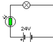
5- Necesito diseñar un circuito que me avise cuando la iluminación en un local disminuye. Para ello coloco una LDR en el local y, en serie con ella, un zumbador. Al accionar el interruptor activaré el circuito y el zumbador debe sonar cuando la iluminación disminuya. ¿Es correcto el montaje? ¿Por qué?
