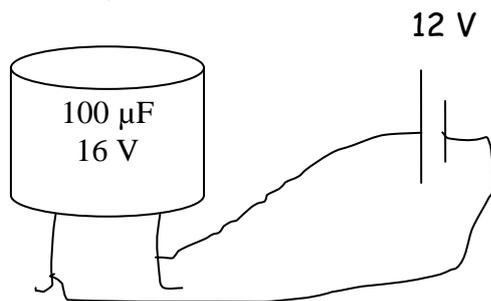
c- Cuando un condensador se está cargando deja pasar la corriente a través de él, pero al finalizar la carga se comporta como un interruptor abierto. La bombilla luce sólo hasta que se carga el condensador.
