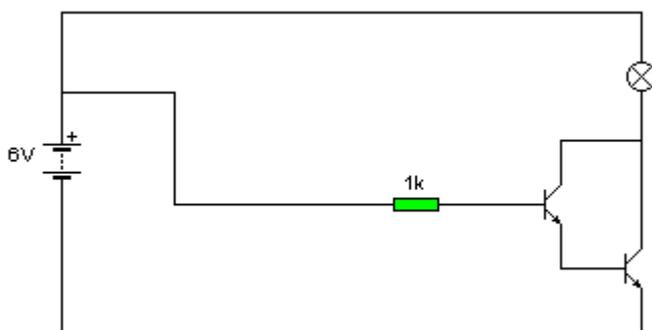
La salida del emisor del primer transistor hay que conectarla a la base del segundo transistor.
