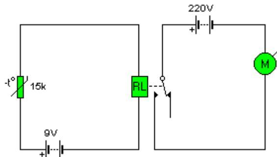
9- ¿Qué tipo de TDR debemos colocar en el siguiente circuito para hacer funcionar el motor cuando la temperatura aumenta, y la bombilla cuando la temperatura disminuye.
