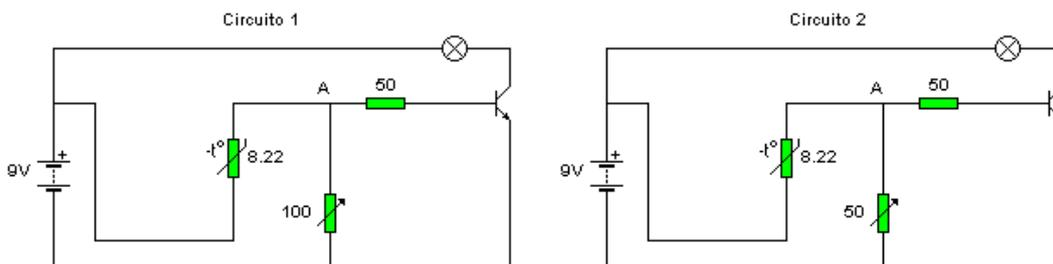
En ambos circuitos al aumentar la Temperatura, disminuye la resistencia de la NTC y la corriente puede llegar al nudo A. A esa determinada temperatura la corriente que llega al nudo puede irse hacia la resistencia protectora de la base de  $50 \Omega$  o hacia el potenciómetro.
