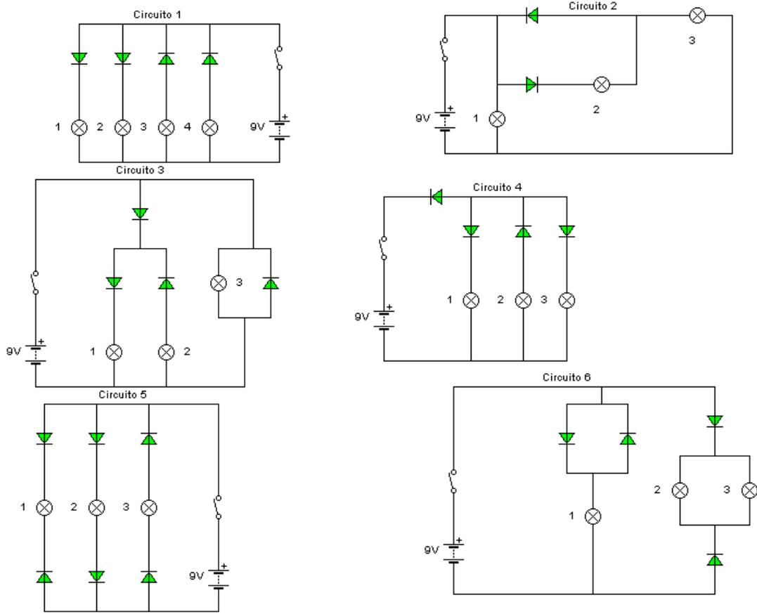
2- ¿Rodea con un círculo los elementos (Motores, bombillas y LED) que funcionarán en el siguiente circuito al accionar el interruptor?
