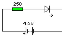
Como la resistencia y el LED están asociados en serie, la intensidad que recorre cada uno de los elementos será la misma, y hemos dicho que al menos debe ser de 10 mA; además como el voltaje máximo que soporta el LED es de 2 V, la resistencia cuyo valor deseamos calcular debe consumir:
