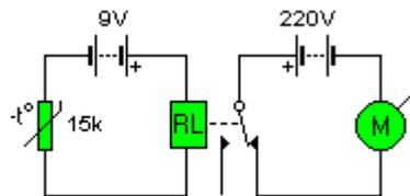
8- El siguiente circuito es utilizado para poner en marcha el motor de un ventilador cuando aumente la temperatura. ¿Qué tipo de TDR deberíamos utilizar? Explica que sucede al aumentar la temperatura.
