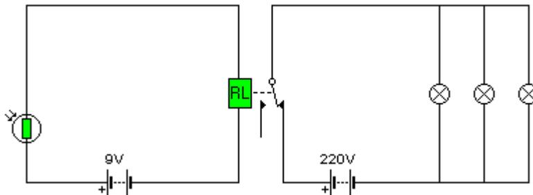
7- El siguiente circuito es un detector de luminosidad que está colocado en un invernadero. Su función es cerrar las cubiertas cuando la iluminación es excesiva para las plantas y abrirlas cuando disminuye.
