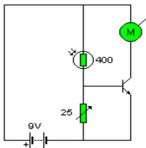
14- Diseñar un circuito por medio del cual se invierta el sentido de giro de un motor cuando se eleve la temperatura.
