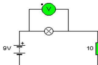
3- Si se sustituye la resistencia fija por un potenciómetro, se pueden conseguir distintos voltajes sobre la bombilla, sólo hay que girar el potenciómetro para modificar su valor. Deduce los voltajes sobre cada una de las bombillas sin aplicar fórmulas. Los valores de los potenciómetros están en  $\Omega$
