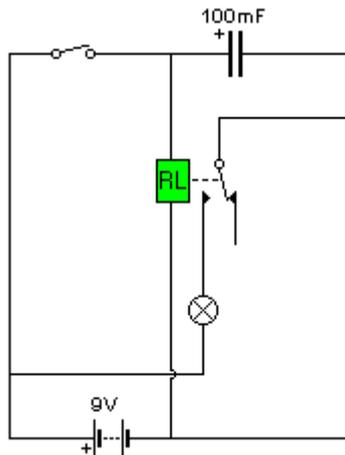
13- Se quiere diseñar un circuito temporizador por medio de un condensador de  $1.000 \mu\text{F}$ , de forma que tarde 10 s en activar un motor asociado a éste. El relé que pone en funcionamiento el motor tiene una resistencia de  $100 \Omega$  y, montado en serie con él, se dispone un potenciómetro. Dibujar el esquema del circuito y calcular la resistencia necesaria que hay que seleccionar en el potenciómetro para lograr la temporización necesaria.
