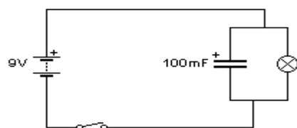
Al accionar el interruptor la corriente eléctrica sale de la pila encendiendo la bombilla y cargando el condensador. Si ahora abrimos el interruptor la bombilla no se apaga inmediatamente ya que el condensador está cargado y se descarga a través de la bombilla. Por eso decimos que se temporaliza el apagado.
