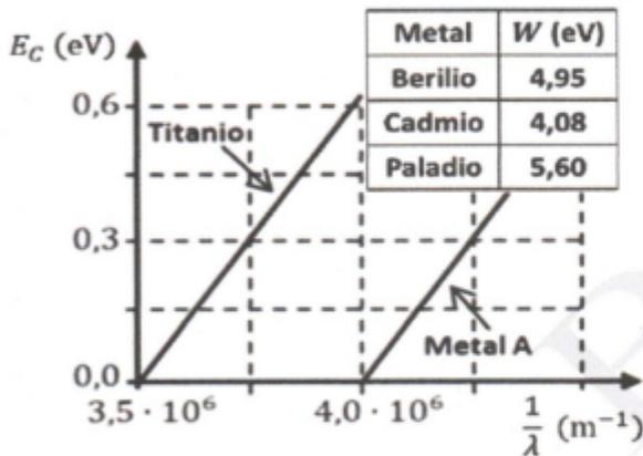
Cuando los fotones de la radiación incidente tienen una energía igual al trabajo de extracción del metal, la energía cinética de los electrones es cero.
