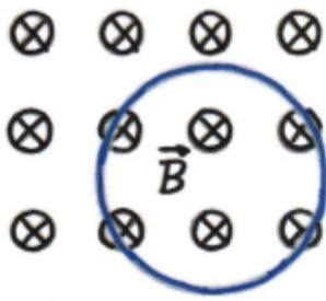
Según la **LEY DE FARADAY-HENRY** sobre la espira se inducirá una corriente si ésta se ve sometida a una variación del flujo magnético que la atraviesa. El flujo magnético viene dado por:
