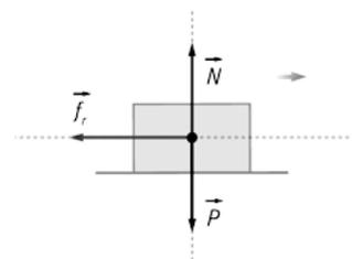
25. Se tira de un objeto de 11 kg de masa, situado sobre un plano horizontal, con una fuerza  $F$  desconocida, que le produce una aceleración de  $1,0 \text{ m s}^{-2}$ . Posteriormente se tira con una fuerza de  $2F$  y la aceleración pasa a ser de  $8,0 \text{ m s}^{-2}$ . Calcula el valor de la fuerza aplicada,  $F$ , y el valor del coeficiente de rozamiento, sabiendo que la superficie es horizontal.
