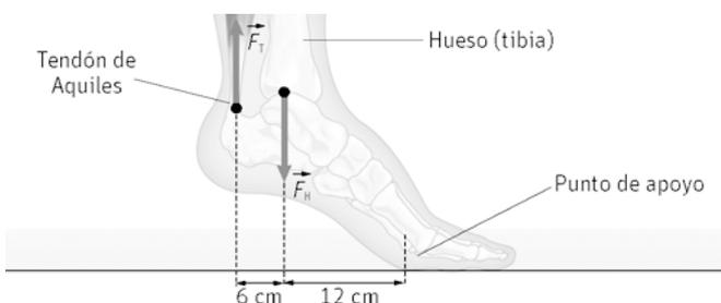
Además de las dos fuerzas que indica el enunciado, sobre el pie de apoyo, actúa la fuerza normal (la reacción al peso). Así el módulo de la fuerza normal coincide con el de la fuerza peso.
