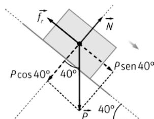
Comenzará a moverse cuando la componente del peso en la dirección del movimiento coincida con la fuerza de rozamiento estática máxima.
