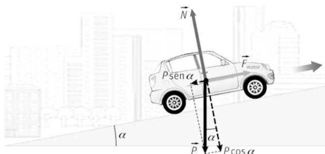
Si  $\alpha$  es el ángulo de inclinación de la pendiente, la dirección del peso y la dirección del desplazamiento forman un ángulo  $\beta = 90^\circ + \alpha$ . Por tanto,  $\cos \beta = -\text{sen } \alpha = -0,06$
