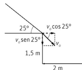
La aceleración con la que baja por la barandilla, se calcula a través del segundo principio de la dinámica. Se descomponen las fuerzas según el dibujo:
