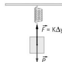
66. Un vehículo deportivo tiene una masa en vacío de 1615 kg y su suspensión se basa en cuatro muelles helicoidales. Suponiendo que el peso del vehículo se distribuye uniformemente entre los cuatro muelles y que con el coche vacío estos están comprimidos 10,0 cm, contesta a estas preguntas.
