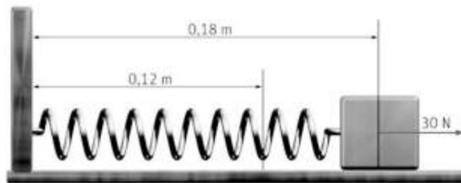
Si recibe una fuerza de 30,0 N, se estira hasta una longitud de 18,0 cm. En esta posición se suelta para que oscile libremente con una frecuencia angular de  $\pi \text{ rad s}^{-1}$ . Calcula
