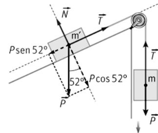
56. En los siguientes sistemas determina la aceleración y la tensión de la cuerda.
