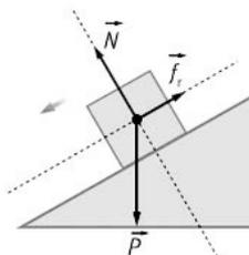
29. Con la ayuda de una fuerza de  $14 \text{ N}$  se sube un objeto de  $2,0 \text{ kg}$  de masa por un plano inclinado de  $25^\circ$ . Calcula la aceleración con la que sube el objeto:
