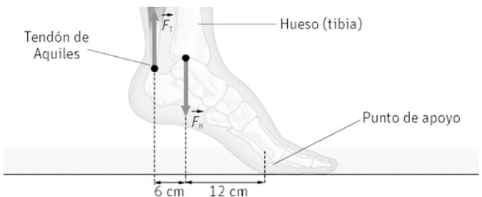
Además de las dos fuerzas que indica el enunciado, sobre el pie de apoyo, actúa la fuerza normal (la reacción al peso). Así el módulo de la fuerza normal coincide con el de la fuerza peso.
