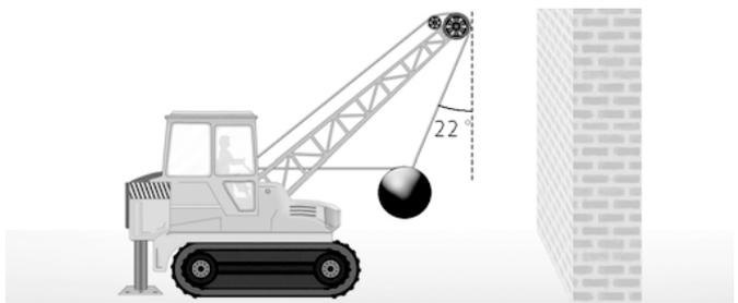
Determina la tensión a la que se ve sometido el cable horizontal si el sistema está en equilibrio.
